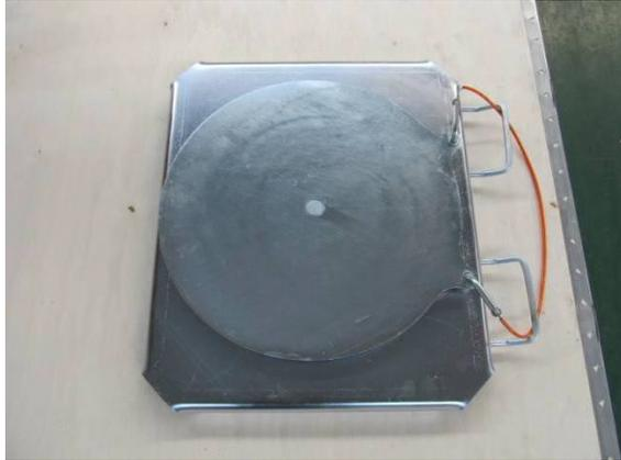
(写真はスチールコーナープレートの分解を示しています)
