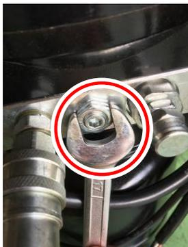
2. 六角レンチで中央のネジを回すと、降下速度を調整できます。
