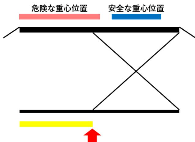
危険な重心位置で上昇させると、↑（矢印）部分に集中荷重がかかり、黄色部の剛性が低い為に折れ曲がり、後方に転倒する可能性があります。
