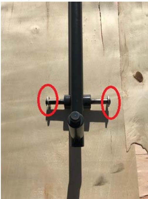
④ シャフトに車輪、その上からOリング2枚を入れて、Cクリップで留めます。実機に合わせて、大小のOリングを使用します。写真では、Oリング(大)を左右に2枚ずつ使用しています。
