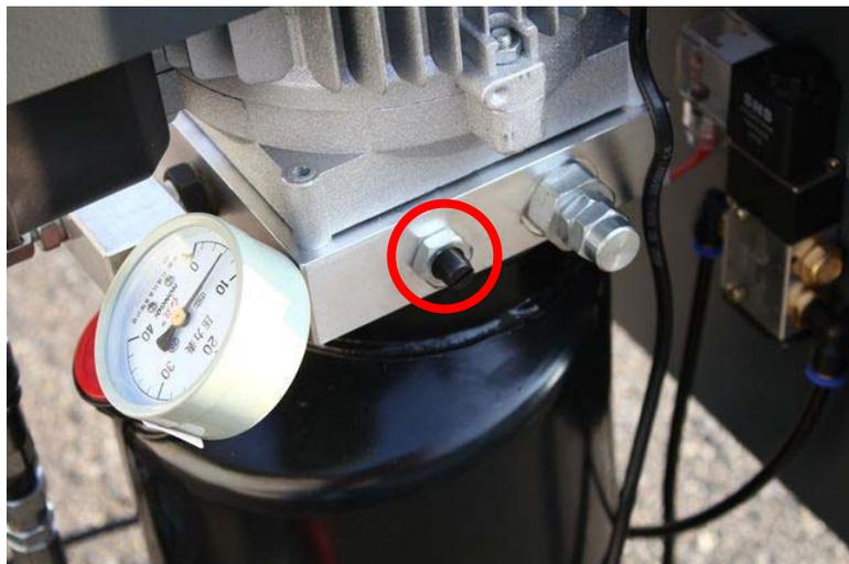
上図の赤丸内の六角ナットを緩め、その中の黒ネジの頭部分を、マイナスドライバーを使用して速度調整をします。(DOWNボタンを押しながら調整するとスピードがわかりやすいです)
